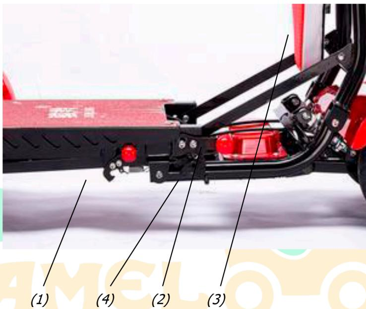
Трицикл установлен в ровном положении, детское сиденье (3) в сложенном положении. Встаньте сзади трицикла и потяните красную сферу (2) вверх, фиксирующий замок раскроется, после чего продолжайте тянуть сферу, трицикл начнет складываться. Для удобства складывания, прихватите рулевую колонку у её основания и потяните её на себя.
